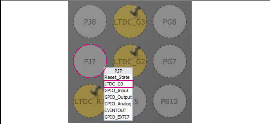
图37. STM32CubeMX：PJ7引脚配置为LTDC_G0备用功能
