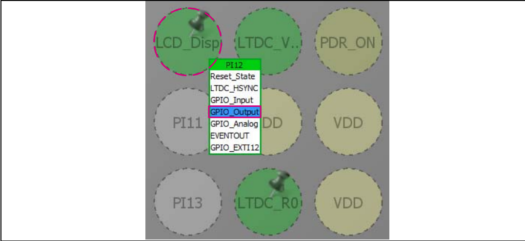
图40. STM32CubeMX：显示器使能引脚（LCD_DISP）配置
