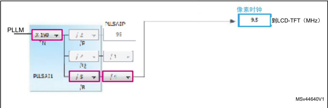
图45. STM32CubeMX：LTDC像素时钟配置
